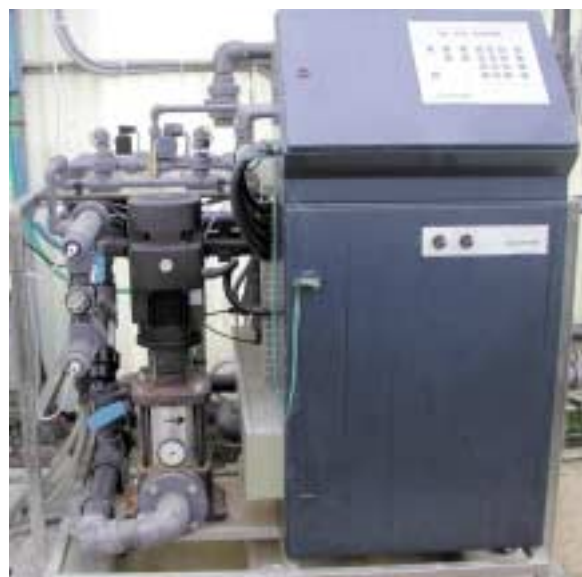
Fertirrigatore computerizzato. Questi sistemi permettono di gestire diverse soluzioni nutritive nei vari settori irrigui
