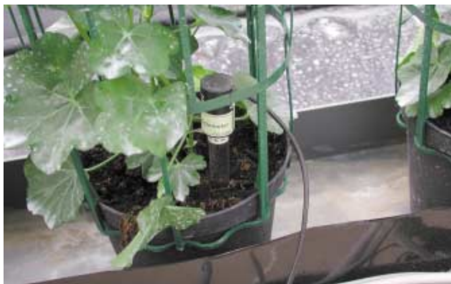
Fig. 2 - Posizione del tensiometro rispetto all'irrigatore; il sensore, inserito a un terzo della profondità del vaso partendo dall'alto, deve formare un angolo retto con l'irrigatore
