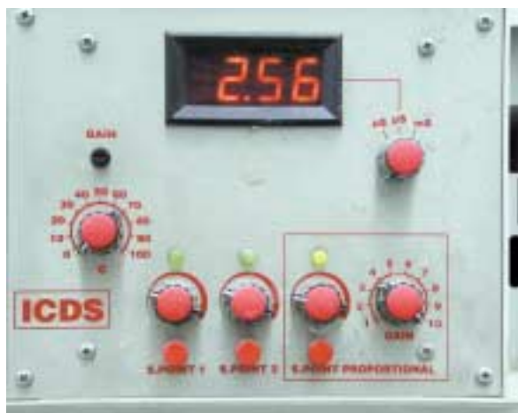
Quadro di controllo di EC per la regolazione di pompe dosatrici in impianti dotati di controllo proporzionale. Si nota, in alto a sinistra, il gain per la calibrazione della sonda, e in basso a destra il regolatore del set-point di EC affiancato sempre a destra dal regolatore della velocità di aspirazione della pompa dosatrice
