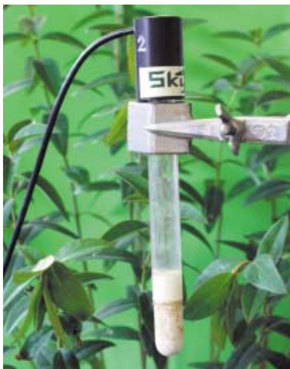
Un microtensiometro per il controllo dell'irrigazione: si noti la coppa porosa, il tubo riempito di acqua e il sensore/trasduttore della tensione
