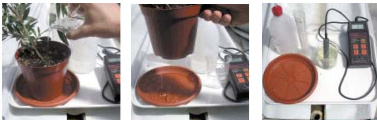
Fig. 1 - Fasi di un'analisi rapida dei substrati condotta con il metodo del percolato: A) aggiunta dell'acqua deionizzata al vaso precedentemente portato alla capacità idrica di contenitore; B) raccolta dell'acqua di percolazione; C) analisi della EC sul percolato
