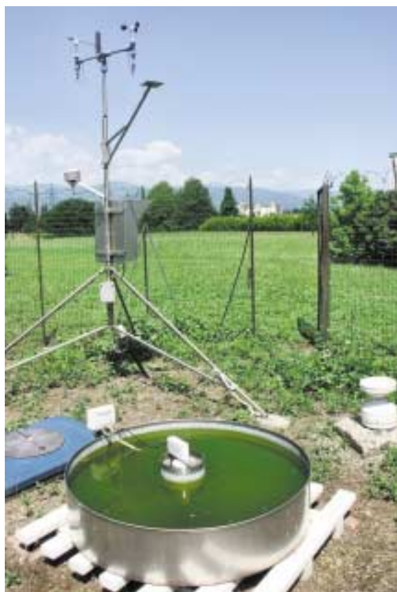
Vasca evaporimetrica automatizzata
