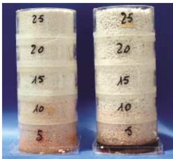
Fig. 2 - Imbibizione di perlite con particelle minori (a sinistra) o maggiori di 2 mm dopo un intervento di subirrigazione di 20 minuti (diametro di base 10 cm, i numeri indicano l'altezza in cm)
