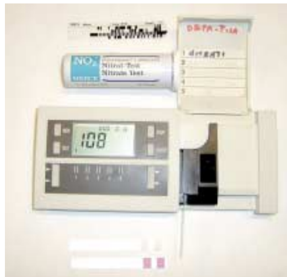
Riflettometro per analisi chimiche rapide. In basso le strisce reattive utilizzate per il saggio colorimetrico (nitrati, in questo caso). Lo strumento prevede una particolare procedura di calibrazione (v. striscia con codice a barre in alto)
